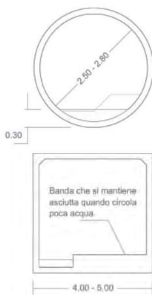
Figura. Esempio schematico di adattamento di tombini di drenaggio e scatolari idraulici per il passaggio della fauna (da Rivella, UTET Scienze Tecniche e Arpa Piemonte).
