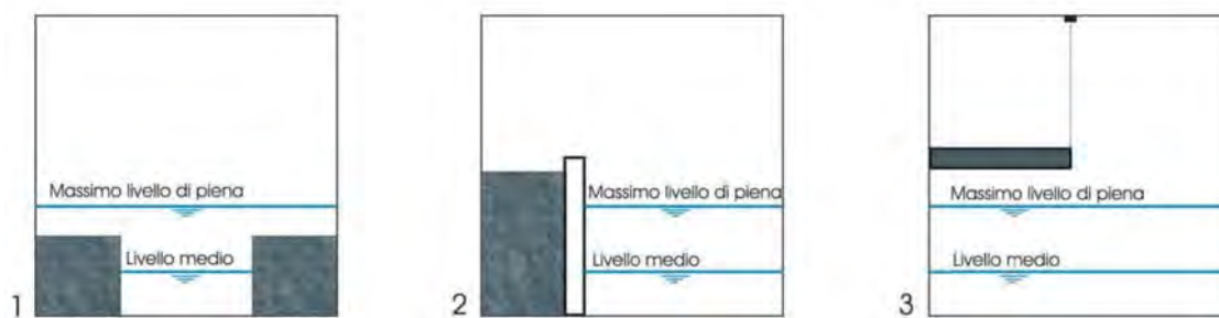
Figura. Esempi schematici di passaggi faunistici in scatolari idraulici: 1) costruzione di due banchine laterali poste tra il letto di magra e quello inondato in periodo di piena 2) costruzione di un marciapiede al di sopra delle acque di massima piena; 3) costruzione di una passerella in legno al di sopra del livello di massima piena (da Arpa Piemonte).
